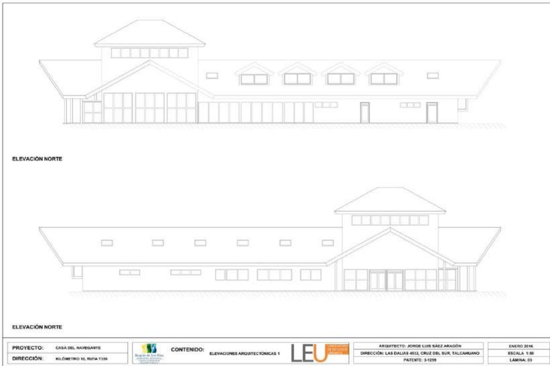
ILUSTRACIÓN 77: ELEVACION ARQUITECTURA 1. CENTRO DE ACOGIDA AL NAVEGANTE
