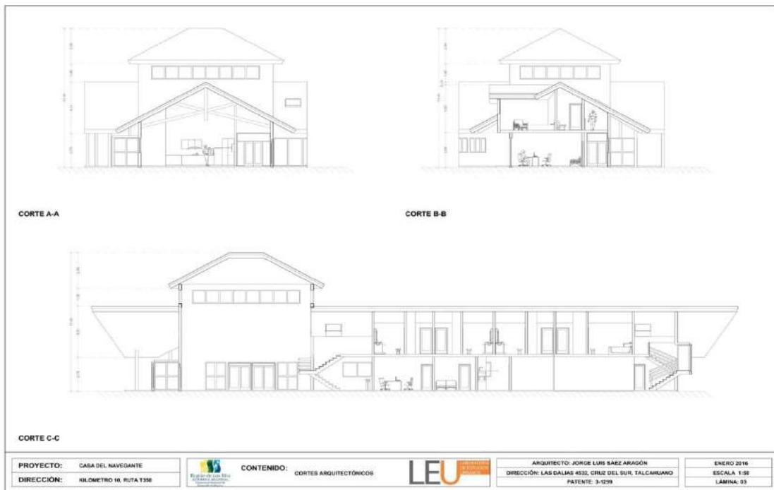
ILUSTRACIÓN 76: CORTE ARQUITECTÓNICO. CENTRO DE ACOGIDA AL NAVEGANTE
